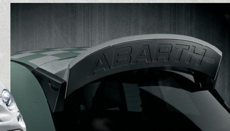
1966 nasce il primo spoiler da gara firmato Abarth: un'ottimizzazione del cofano in resina piena per migliorare l'aerodinamicità della vettura. Oggi, celebriamo questo spirito di innovazione con il nuovo Spoiler ad Assetto Variabile, regolabile da 0 a 60 gradi.
